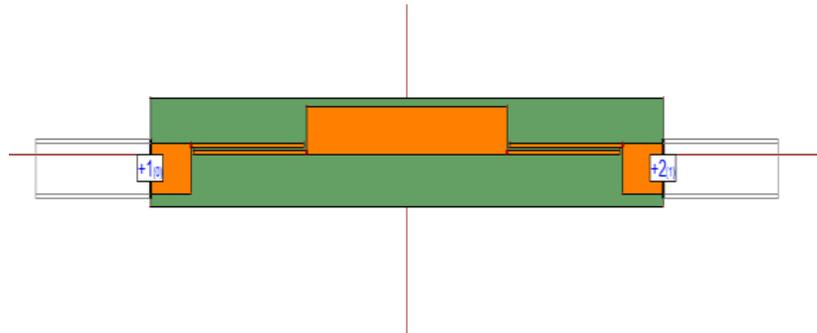
**Fig.7 Multiple-Mode Resonator**
